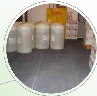
Las rejillas Fibergrate® se utilizan en bodegas de almacenamiento de productos químicos, barriles u otros contenedores. La malla abierta de la rejilla, permite el drenaje en caso de derrames o fugas accidentales.
